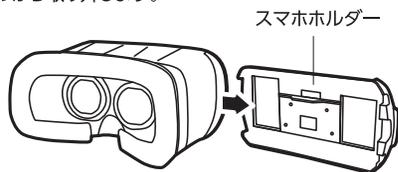
③スマートフォンをスマホホルダーに取り付けます。この時、スマホの液晶画面の中心線が、ホルダーの中央にくるように取り付けてください。
