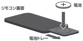
リモコン底部の電池トレイを引き出してください。電池の背面が「+」側になるようにして新しい電池を入れてください。
