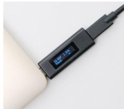
USB Type-C コネクタに接続して、機器に流れる電流や電圧を計測できる、USB テスターです。充電をしているスマートフォンと充電ケーブルの間に接続するだけで、ケーブルや機器の給電能力をチェックすることができます。
